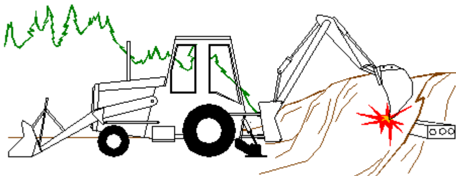
Figura 1 – Contatto con linee elettriche interrato
